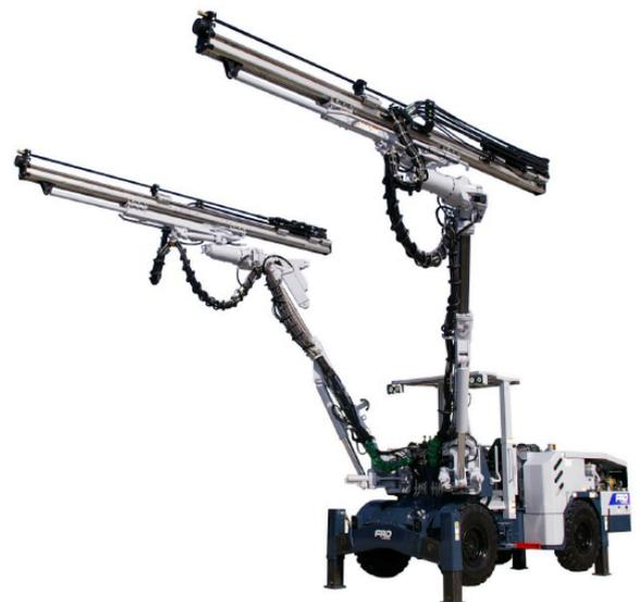
Equipo de perforación de túneles controlado hidráulicamente, con dos brazos telescópicos con paralelismo automático. Cuenta con un motor diesel de alta potencia, que le permite enfrentar trabajos a gran altura geográfica. Posee un **Drifter FRD HD220** con potencia 20 kW y un motor 119 kW... el más potente de su clase.
