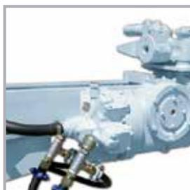
Robusto tren de rodado de bajo mantenimiento y larga vida útil. Incluye dispositivo en brazo para realizar barrenos horizontales.
